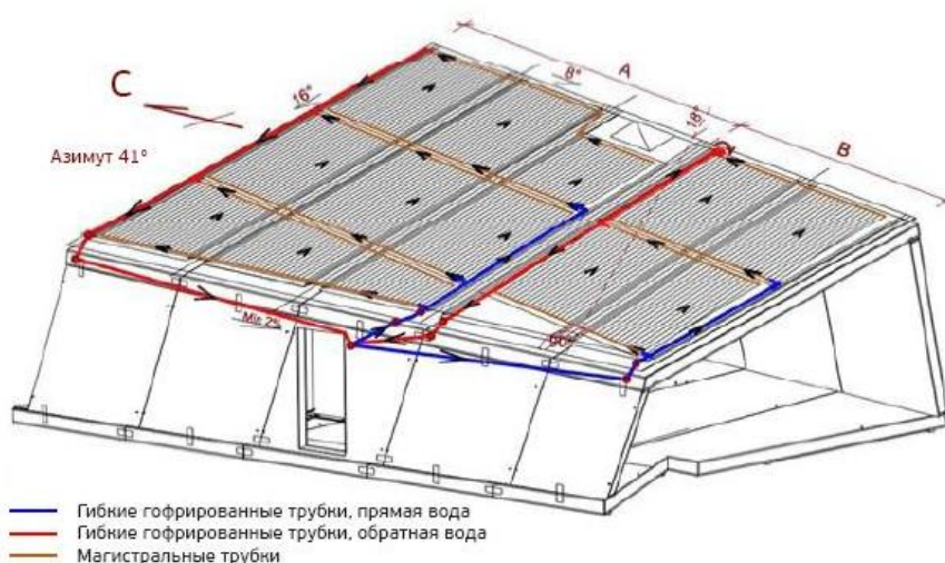
13-сурет – Гибридтік күн коллекторының гидравликалық бөлігінің аксонометриялық хемасы
